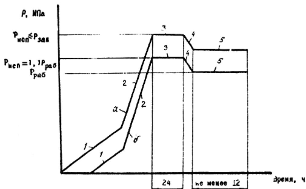
Рис.9. График изменения давления при гидравлическом испытании трубопроводов
