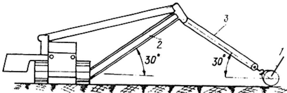
Рис.19. Схема фиксации продувочного патрубка трубоукладчиком:
