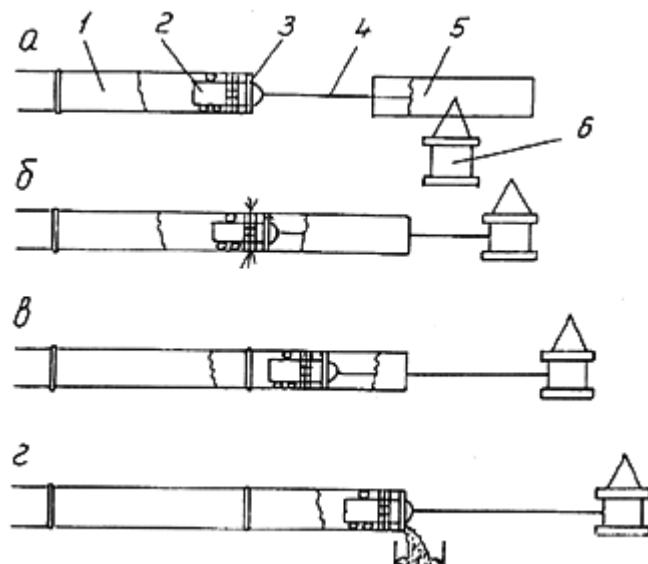
Рис. 3 Принципиальная схема предварительной очистки полости газопровода
