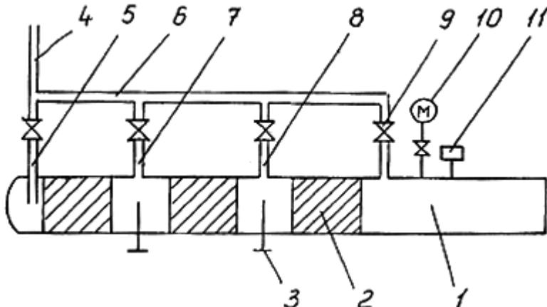
Рис 5. Принципиальная схема камеры пуска очистных поршней при продувке:
